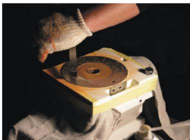
オーバーホールとは、工作機械の精度を向上しロングライフ化するために工作機械を部品単位まで分解し、洗浄作業・塗装作業を行い、摺動面(スライド等)の摺合せや精度出しを行いながら、再組立を行うことで、新品購入時の状態に戻すことです。熟練技術者があらゆる国のあらゆる工作機械に対応し、新品に劣らない機能と精度をよみがえらせます。
