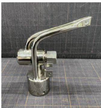
クリーニング業界向けの染み抜き機の先端ノズル(最重要部品)。これらの部品をロー付けして、バフ研磨を施し、ニッケルメッキをして、アッセンブリーまでして納品をさせていただきます。
