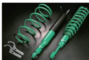
設定車高を純正から約1.5インチアップしたロードクリアランスにより、市街地からオフロードまで様々な走行ステージに対応します。ストロークが確保しやすい複筒式とシールド構造の採用で高品質とリーズナブルプライスを両立します。hidro・バンプ・ストッパーや減衰力調整機構も搭載し、減衰力調整を車内から簡単におこなえるEDFCシリーズにも対応しています。 ※一部車種は非対応
