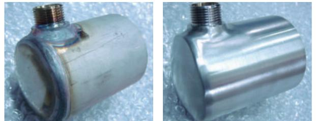
表面ヘアライン仕上げにより、右写真のように仕上がります。単一方向に向かって研磨することで、金属表面に細かな線が入ります。マグカップや階段の手すりに活用されている加工法です。
