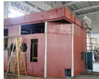
騒音を発する機器をそのまま稼働をさせると近隣に騒音を放ち環境問題となるため、吸音構造を装備した消音カバー（エンクロージャー）で条例などに定められた規定値以下の騒音レベルにします。写真は消音装置を装備した防音カバーの一例です。
