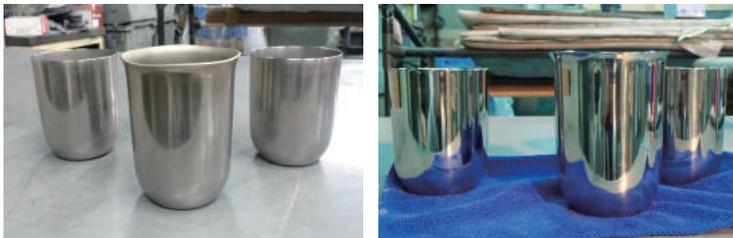
バフ研磨加工により、ステンレスの表面が右写真のように仕上がります。鏡面仕上げは、扱う素材の形状によって研磨に使う道具を使い分けており、食器類や電車内の手すり等に活用されている加工法です。小物精密部品の微細なバリ取りや鏡面仕上げなども可能です。
