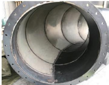
溶射の技術を応用して当社が独自に開発した「テロプレート」は、業界内でも圧倒的なシェアを誇る耐摩耗プレートです。軟鋼板またはステンレス板の表面に特殊コーティングをした硬化層は、均一で高硬度を有し、表面は非常に滑らかで摩擦抵抗が少なく、耐研摩性に優れています。軽量で加工性も高いため、多様な設計製作が容易に可能です。サイクロン・攪拌機・混練機・送風機・空気搬送用のバンド管など様々な場面で活用されています。抜群の耐摩耗性と耐腐食性を備えた「テロプレート」は、発売開始から20年の実績が高く評価
