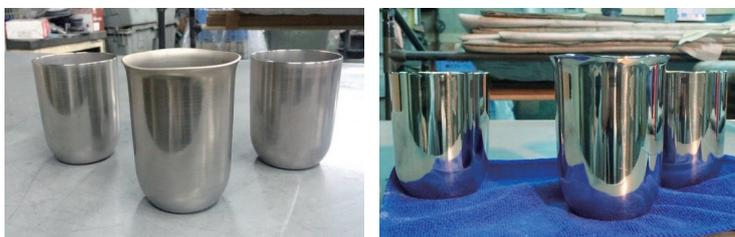
バフ研磨加工により、ステンレスの表面が右写真のように仕上がります。鏡面仕上げは、扱う素材の形状によって研磨に使う道具を使い分けており、食器類や電車内の手すり等に活用されている加工法です。小物精密部品の微細なバリ取りや鏡面仕上げなども可能です。
