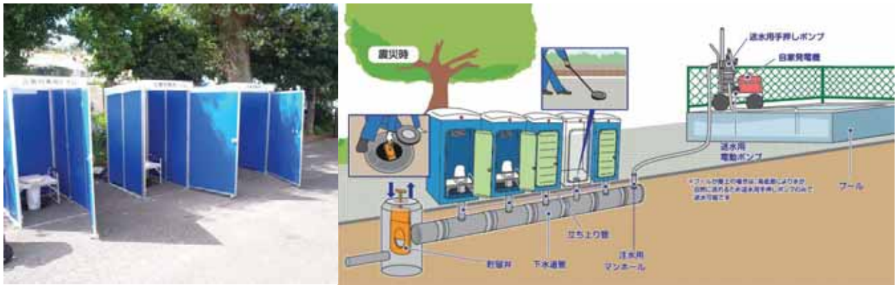
下水直結式仮設トイレ（災害用ハマッコトイレ）
