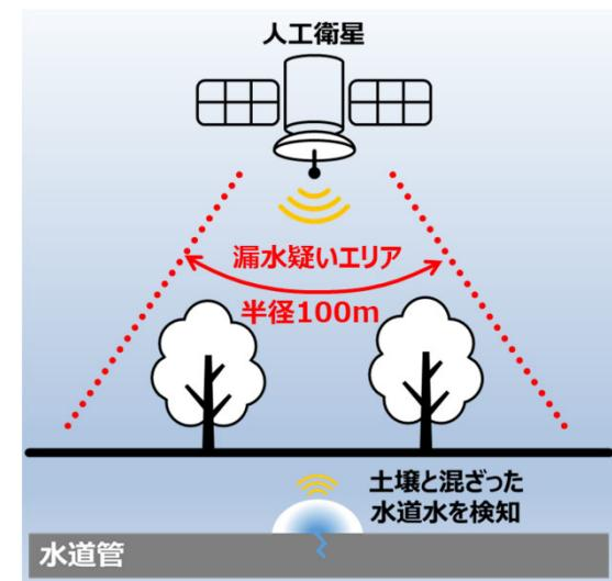
衛星による漏水探知のイメージ
