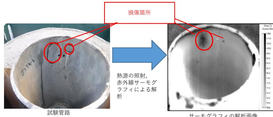
赤外線サーモグラフィによる損傷箇所の特定の様子（共同研究）
