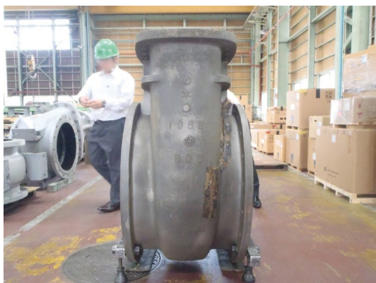
バルブ破損状況
