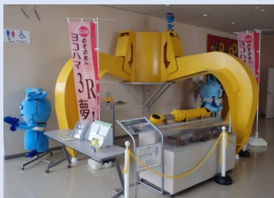
焼却炉にごみを投入するための装置の実物大模型
