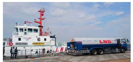
LNG 充填中のタグボート
