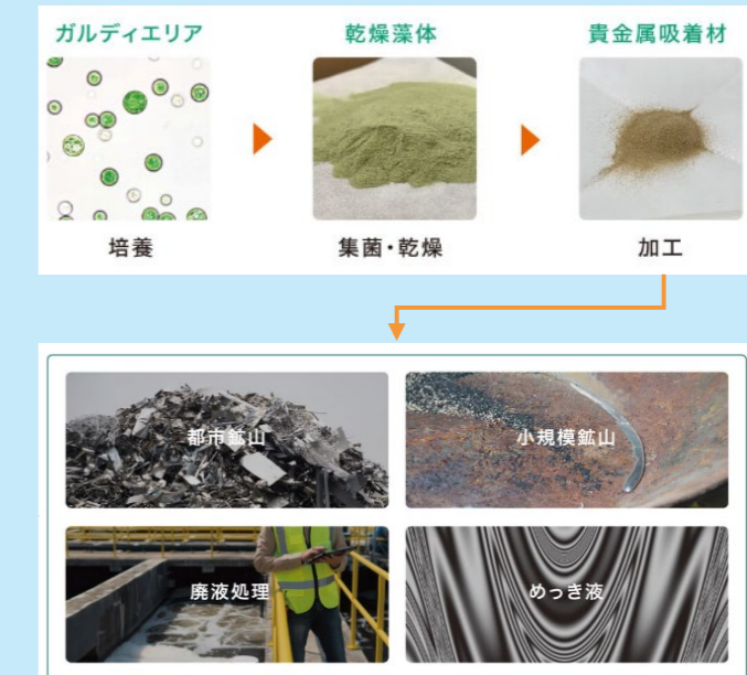
ガルディエリア貴金属吸着剤の製造・利用フロー
