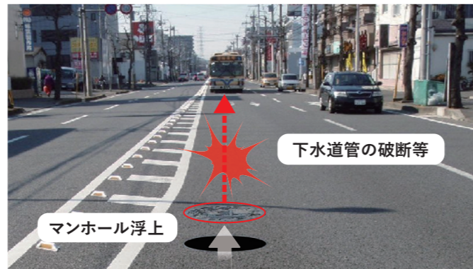
緊急輸送路の下水道管の耐震化
