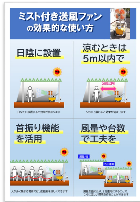
図 22 ミスト付き送風ファンの効果的な使い方を記した啓発資料の表面
