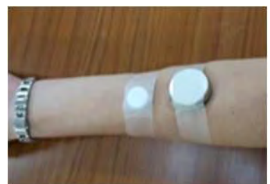
図5 腕に装着した皮膚ガス採取キット
