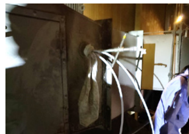
立入検査の様子 (煙道中の排出ガスの採取) ※写真の一部を加工しています
