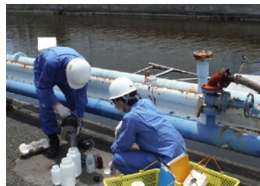
立入検査の様子 (公共用水域への排水の採取) ※写真の一部を加工しています
