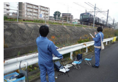
鉄道騒音・振動の測定の様子
