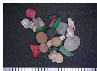
調査で確認されたマイクロプラスチック (写真下部のスケールの1目盛は1mm)
