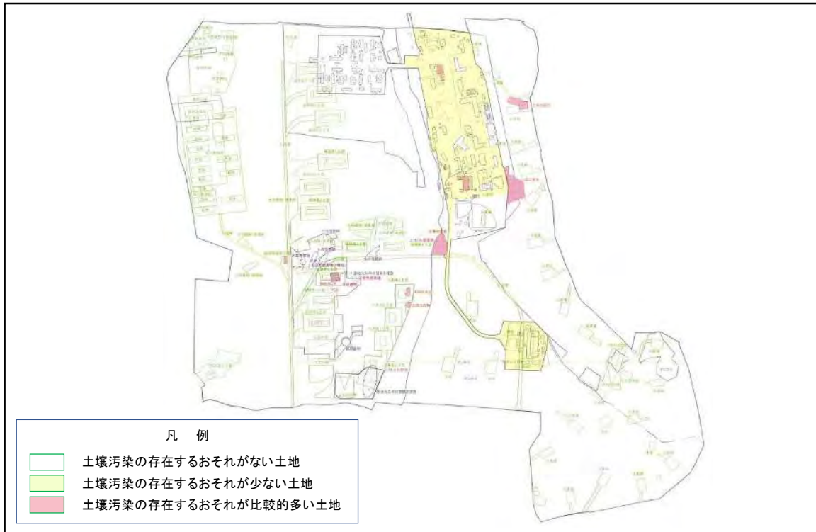
図9.9-2(1) 土壤汚染のおそれのエリア区分 (1,1,1-トリクロロエタン、テトラクロロエチレン、1,1-ジクロロエチレン、シス1,2-ジクロロエチレン、トリクロロエチレン)
