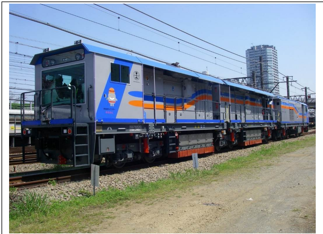
写真 2.3.1-5 環境保全のための措置の実施状況（レール削正車）
