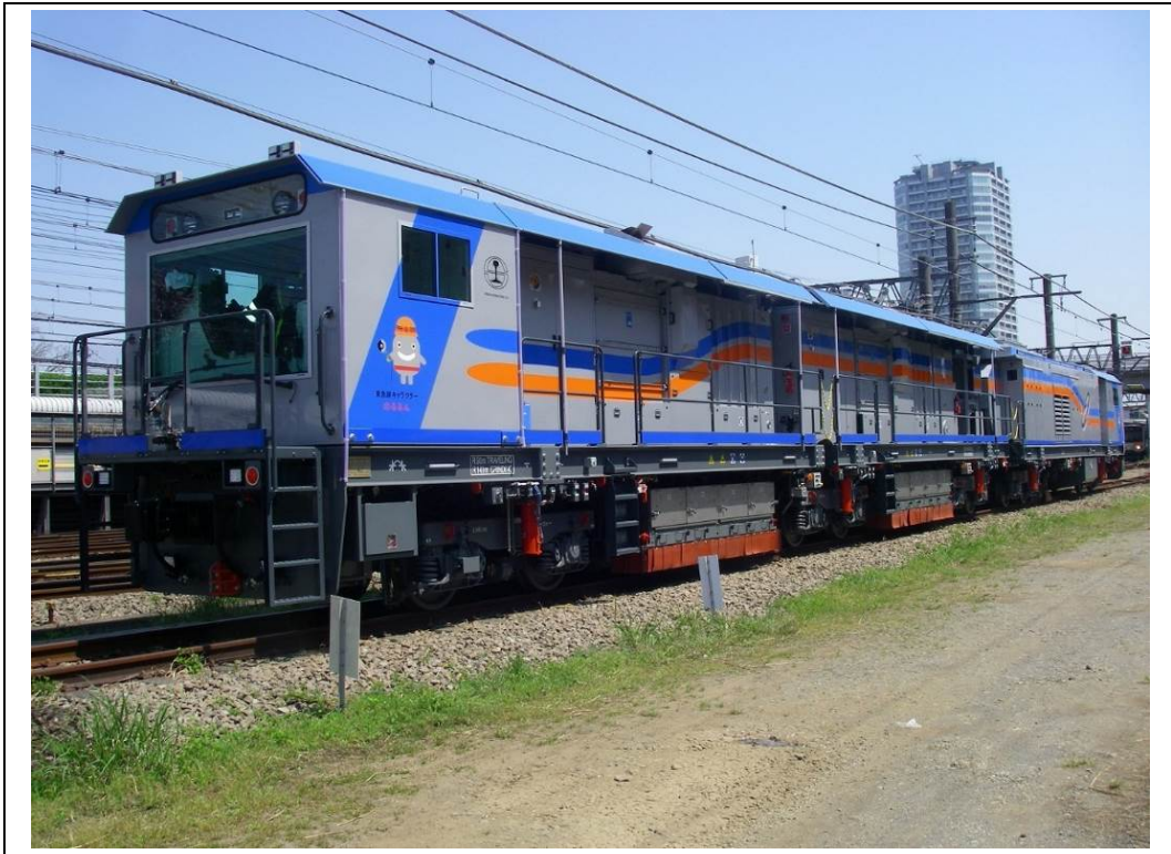
写真 2.3.2-3 環境保全のための措置の実施状況（レール削正車）
