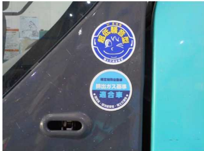
写真 2. 4. 4-4 環境保全のための措置の実施状況（環境対策型建設機械の使用）
