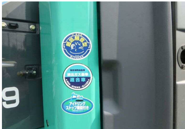
写真 4-5 環境保全のための措置の実施状況（環境対策型建設機械の使用）
