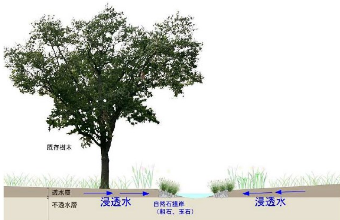
図 7.1-1 保全対象種の生息環境（湧水起源の小水路環境）の創出に係る断面イメージ図
