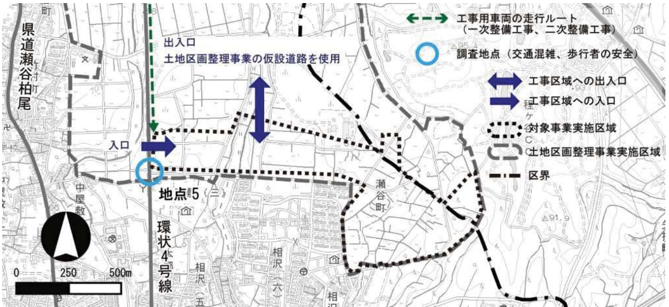
図 9-1 一次整備工事時の工事用車両の工事区域の出入口
