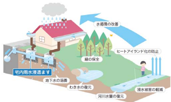
雨水浸透ますの設置
