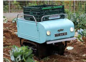
検証した自動追従運搬ロボット（瀬谷区）
