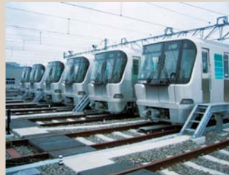
▲市営地下鉄グリーンラインの省エネ型車両
