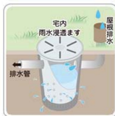
雨水浸透ます
