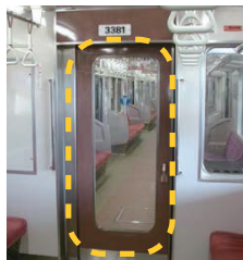
●貫通扉(延焼防止)
