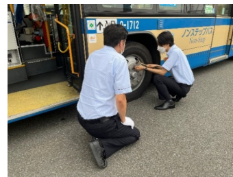
▲運行前点検（ナットの緩み確認）
