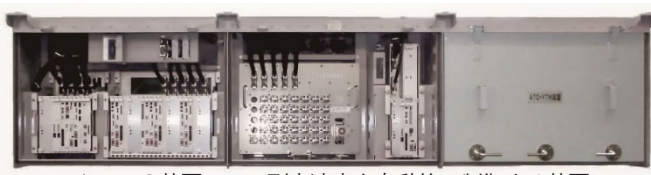
▲ A T C 装置・・・列車速度を自動的に制御する装置
