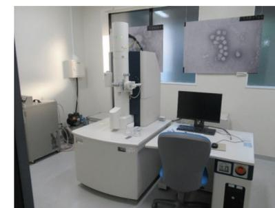
衛生研究所の電子顕微鏡
