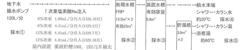
図 浄水処理・給水設備概要
