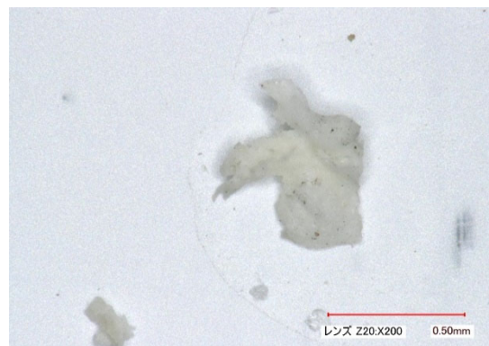
写真3 受水槽No.1の白色油状異物(200倍)
