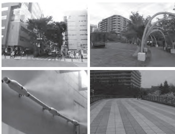
(左上から時計回りに) 街路樹で木陰づくり、暑熱緩和アーチ、遮熱性舗装、ミスト式冷却機
