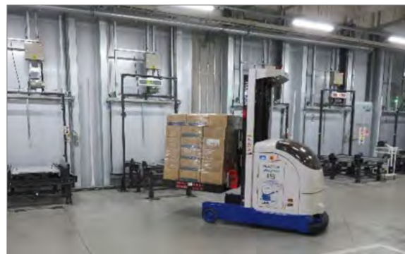
【A | 搭載無人フォークリフトでの貨物の運搬】
