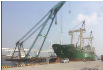
【クレーン台船による荷役】
