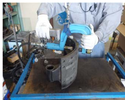
<ライニング張替え作業>
