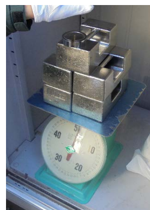
計量器の定期検査の様子
