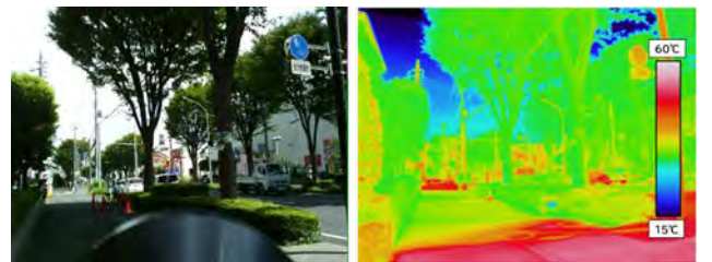
街路樹での熱環境調査の様子（泉区）
