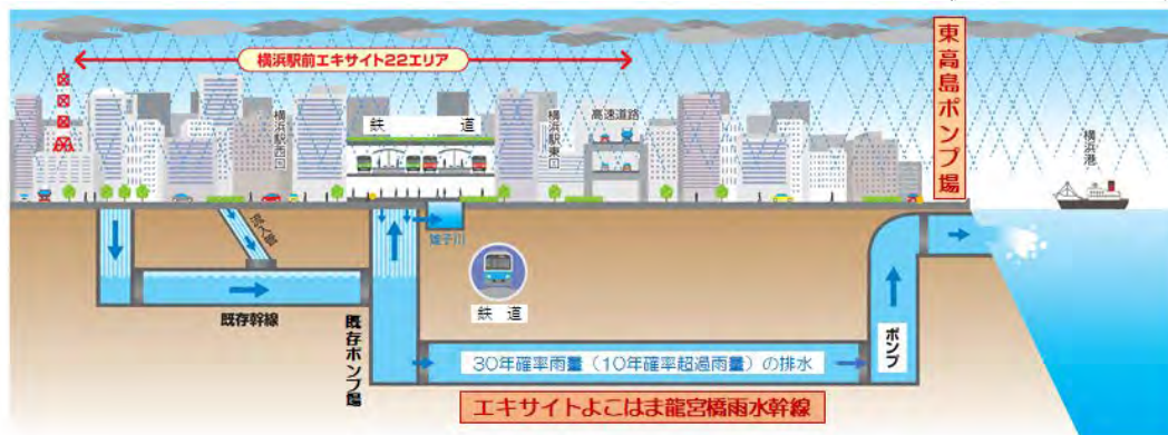
図2 横浜駅周辺の下水道事業によるハード対策イメージ図
