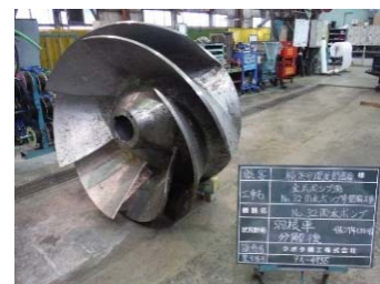
ポンプの再整備（長寿命化）
