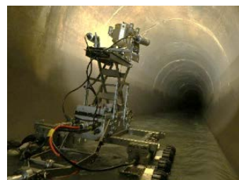
中大口径管用 TV カメラの例
