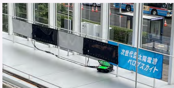
ペロブスカイト太陽電池の実証実験 (市庁舎アトリウム)
