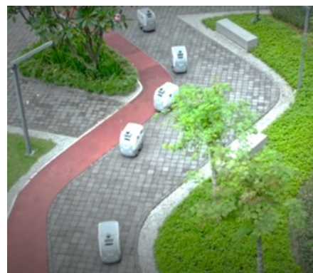
自立走行ロボットによる自動配送
