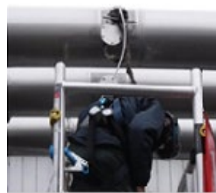
排ガス測定の様子 (煙道からの試料採取)
