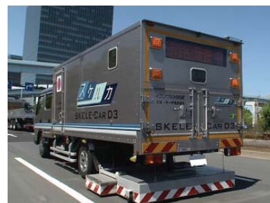
空洞探査車による調査
