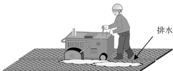
図表2-1-2-12 舗装切断作業のイメージ
