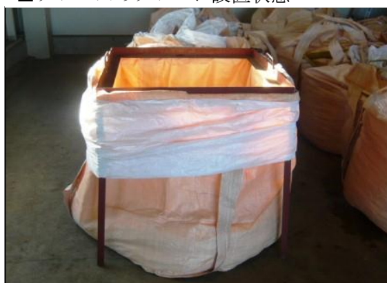
■ フレームのフレコン設置状態
