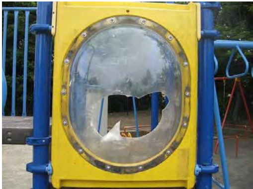
▲ ドームパネル破損
