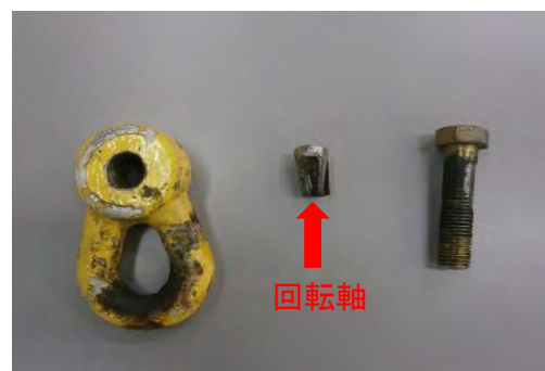
▲ 回転軸の破損
