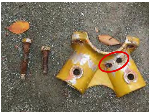
▲ ブランコ支柱継ぎ手金具（鋳物）の穴
