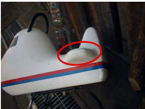
▲ 本体の亀裂（FRP製）
