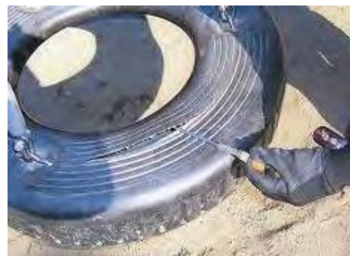
▲ 座面(タイヤ)の破損
