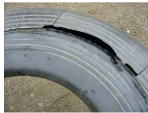
ゴム系素材の劣化状
