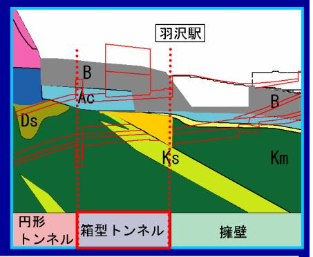
B:混合土(盛土層) Ac:粘性土(沖積層) Lm:粘性土(関東ローム層)
