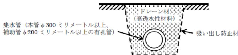
図V.2-3 暗渠排水工の基本構造
