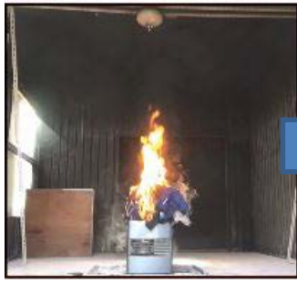
ストーブから出火センサーが熱を感知
