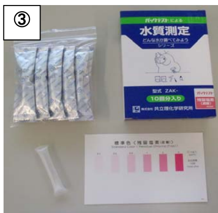
③ 残留塩素測定試薬
