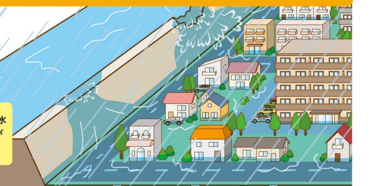
洪水(河川氾濫)とは、大雨によって河川などの水位が上昇し、堤防を越えて水があふれたり、堤防の土砂が流出して決壊したりすることです。
