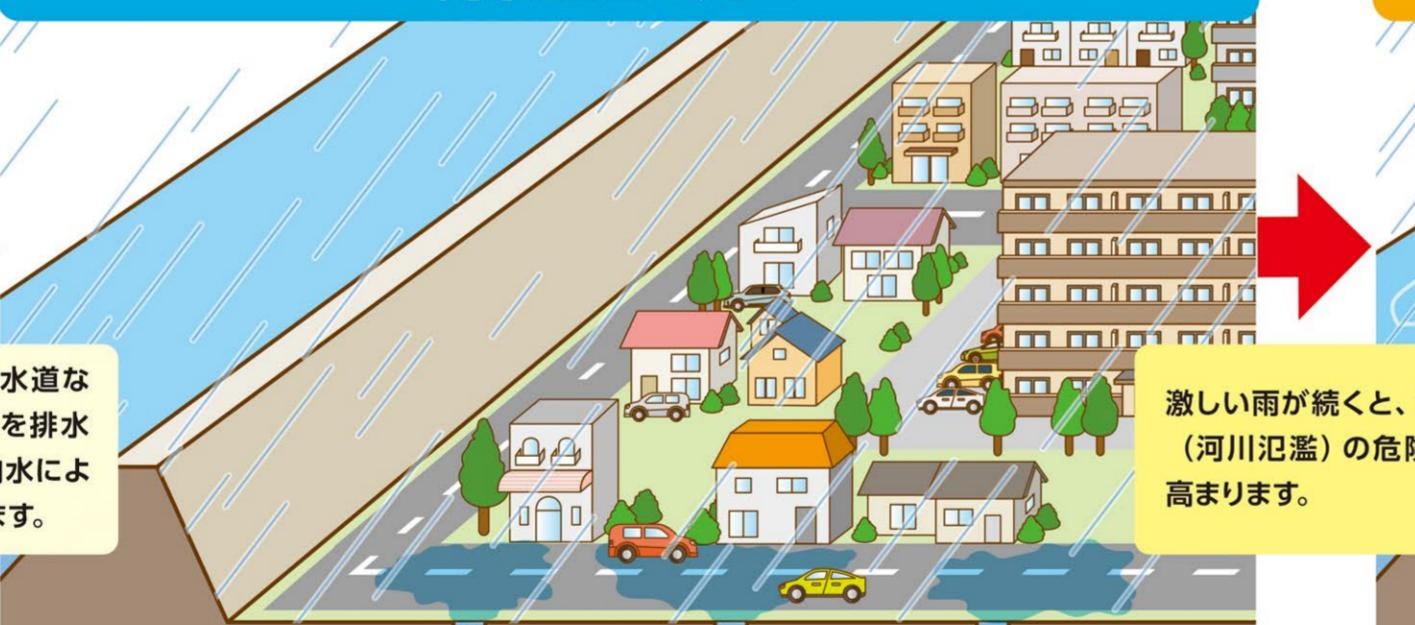
内水氾濫とは、雨の量が下水道などの排水能力を超えたときや、河川などの排水の水位が高くなったりときに雨水を排水できなくなり、浸水することです。
